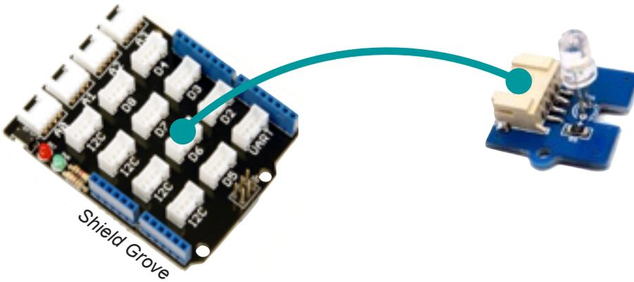
La del se connecte sur l'un des ports D2 à D8
