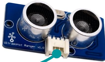
Le capteur à ultrasons utilise 2 ports (exemple ici avec D2 et D3)
