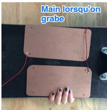
Pour ce test, tout d'abord, nous avons utilisé un échantillon d'une plaque de cuivre soudée avec un capteur tactile, et nous avons créé le programme avec l'aide du groupe de programmation. Nous avons utilisé le logiciel Arduino.
