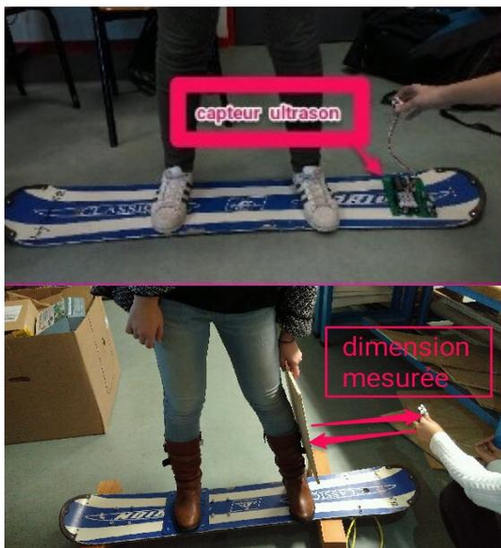
Nous avons fait plusieurs tests, mais on a rencontré un problème majeur : le capteur positionné ainsi (voir photo ci contre) ne capte pas à tous les coups les jambes du rider : les ultrasons passent à côté sans forcément « rebondir » sur les jambes.
