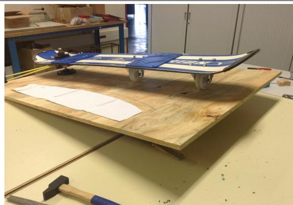
Il nous fallait construire un snow qui puisse bouger sur l'axe Z (rotule et roulette) et aussi sur l'axe X (rotule et roulette) pour cela nous avons réalisé un modèle 3D du snow sur Sketchup puis nous avons construit le modèle réduit.
