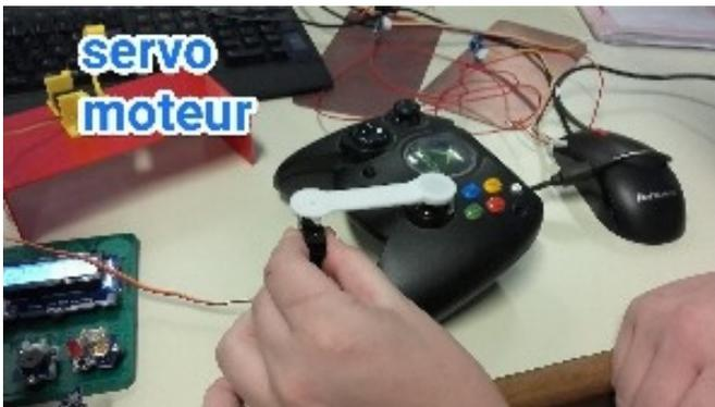
Avant de commencer, nous avons testé si la force que génère un servo moteur permettait de venir appuyer ou déplacer les joysticks de la manette, le groupe programmation a réalisé le programme pour nous. Le test est concluant. C'est bel est bien cette solution que nous retenons.
