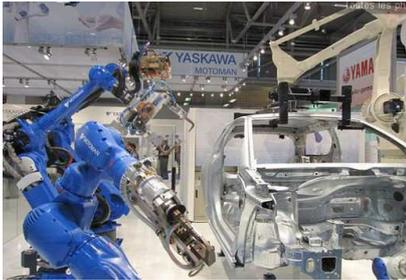
On appelle robot industriel un système polyarticulé permettant de déplacer et d'orienter un outil ou "organe effecteur" dans un espace de travail. Pour des raisons de sécurité, ces robots sont installés dans des cages ou des carters pour éviter que l'on s'en approche trop. Les robots industriels sont désormais munis de systèmes de vision qui accroissent leur souplesse d'exécution et permettent de vérifier la qualité des produits fabriqués.
