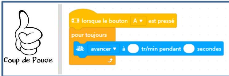
Le morceau de programme ci-dessus permet lorsque l'on appuie sur le bouton A du CyberPi de faire avancer le Mbot2.
