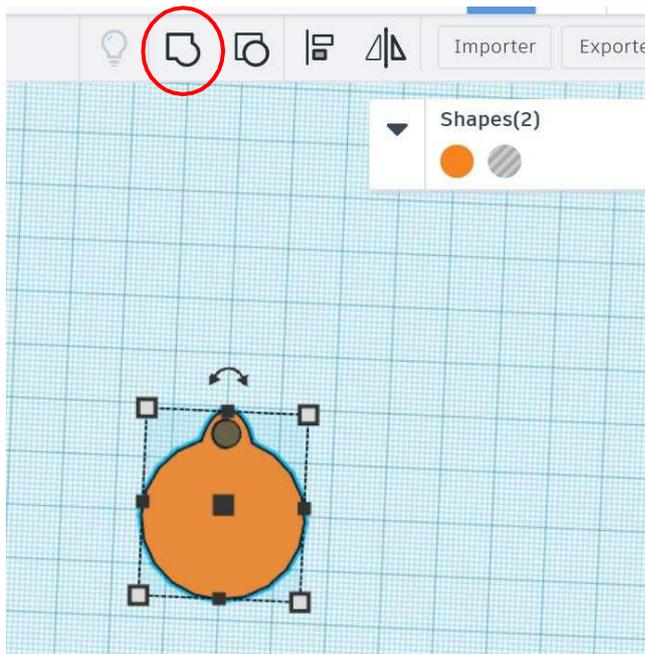
Réaliser un évidement de 23mm de diamètre et 1mm de profondeur
