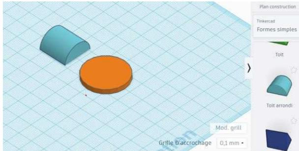
dans la vue de côté, tourner le toit à  $-90^\circ$
